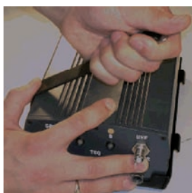
Fissaggio dell'unità DSCP Tracker alla piastra di base usando le cin gommate
